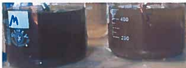
Figura 6 – Ensaios de Tratabilidade (Amostra 1 e Amostra 2) – Teste de Decantação
